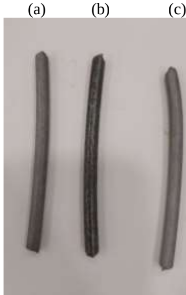
Şekil 13. (a) 1. Havuzda 20 dk bekletilmiş numune. (b) Yeni Filmaşın (c) 2. Havuzda 5 dk bekletilen numune
