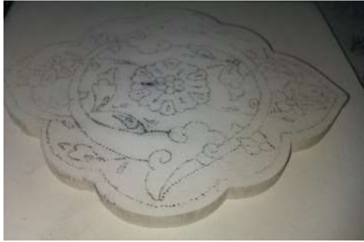
Resim 61: Kitaplığın Tuğlarının Yan Taraflarına Çizilmiş Olan Desenin Kömür Tozuyla Bisküviye Geçirilmesi.
