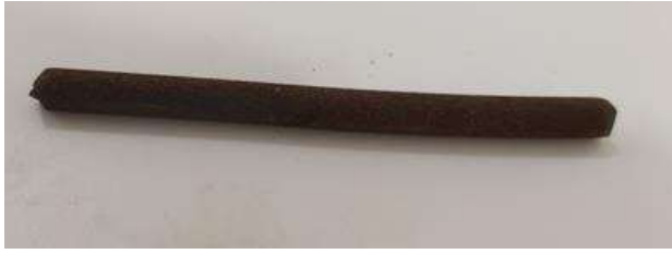
Şekil 7. Paslı filmaşının kesiti ve yüzeyi
