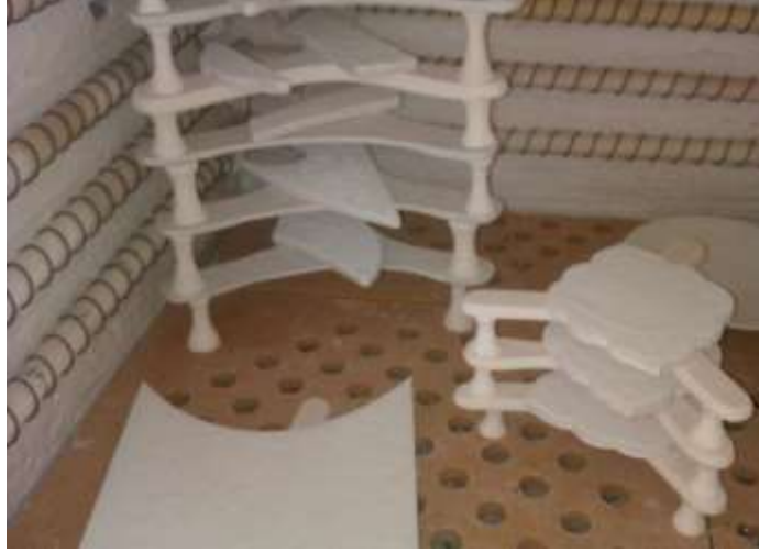
Resim 68: Bisküvilerin Fırına Yerleştirilmesi.
