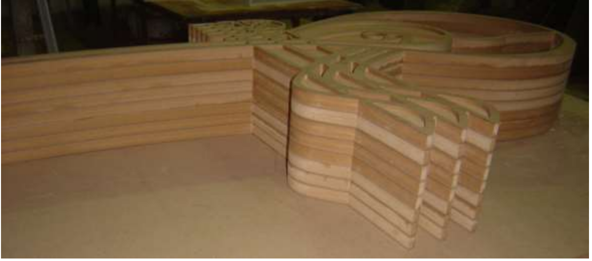
Resim 46: Tuğra Formundaki Çinili Kitaplık, Sekiz Kat Kesilmiş ve Yapıştırılmıştır.
