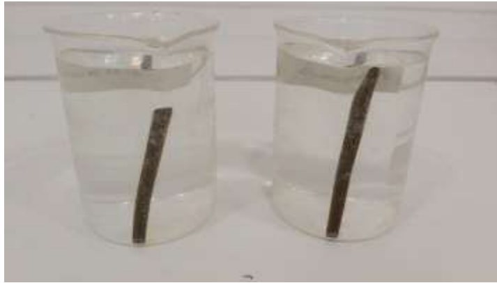
Şekil 8. Hazırlanan havuzlara paslı filmaşınların konulması
